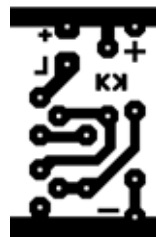
Platinenlayout Originalgröße 20 x 33 mm
